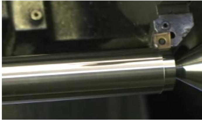
Fig. 10. Stable machining ( $D = 38$  mm)
