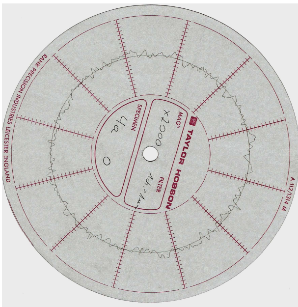
Rys. 17. Wykres kołowy odchyłek okrągłości dla powierzchni wałka obrobionego ściernicą ze ścierniwem 38A
