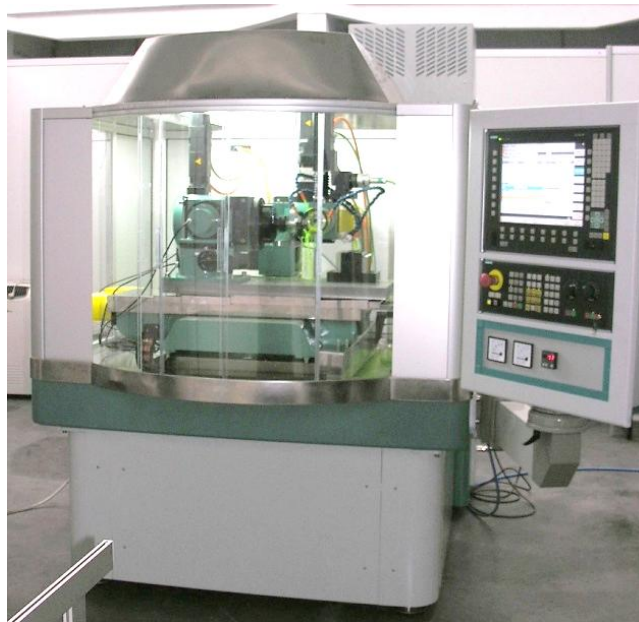
Rys. 6. Modułowa szlifierka ścierno-elektroerozyjna MESO 25 CNC Fig. 6. Modular abrasive – electro – erosion grinding machine of MESO 25 CNC
