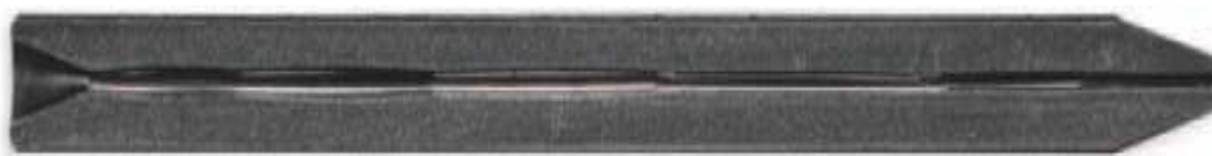
Rys. 10. Przekrój wzdłużny dyszy ścierniej – postać zużycia wzdłuż dyszy
