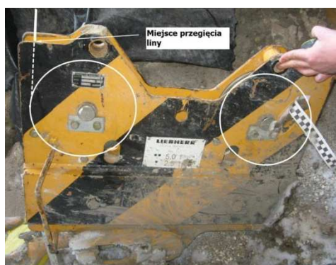
Rys. 13. Widok zblocza dźwigu z zaznaczonym miejscem zerwania liny Fig. 13. Pulley block with the indicated spot of rope failure
