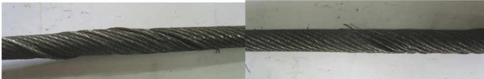
Rys. 6. Zdjęcie deformacji spletek i pojedynczego pęknięcia drutu Fig. 6. Strand deformation and a single broken wire (photo)
