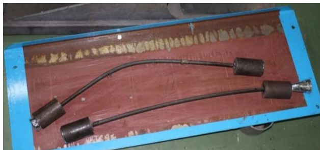
Rys. 10. Widok wybranych odcinków lin do badań niszczących zalanych w stożki Fig. 10. Rope sections selected for destructive testing, filled in tapered sections
