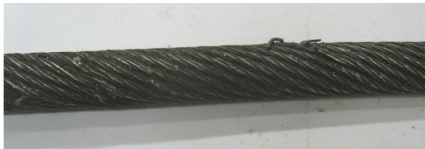
Rys. 3. Zdjęcie liny z uszkodzeniami Fig. 3. Wire rope from damage
