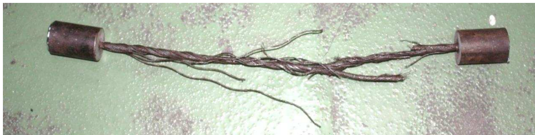
Rys. 11. Widok próbki liny o największym zużyciu po zerwaniu Fig. 11. Maximally worn rope sample after failure
