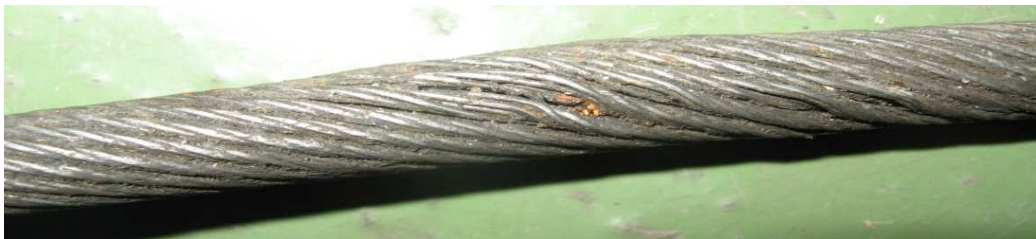
Rys. 7. Zdjęcie deformacji i starć spletek warstwy zewnętrznej Fig. 7. Deformations and abrasions of strands in the outer layer
