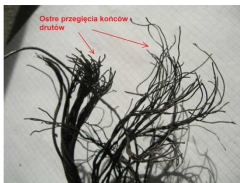
Rys. 12. Ukształtowanie spletek i drutów zerwanego odcinka liny Fig. 12. Strands and wires in the broken rope section
