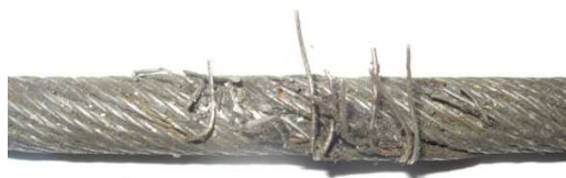
Rys. 4. Zdjęcie skupiska uszkodzeń wraz z zerwaną splotką Fig. 4. Concentration of rope damage: broken strand
