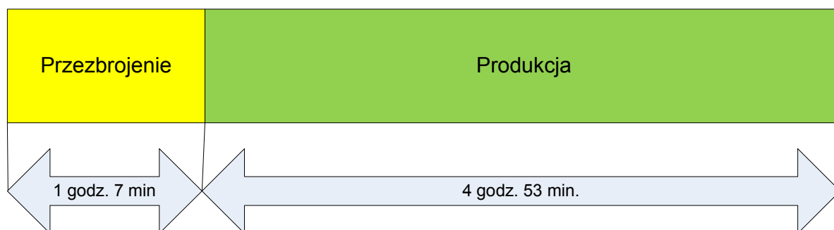
Rys. 3. Zestawienie czasu przebrojenia z czasem produkcji Fig. 3. Summary of changeover time with the time of production
