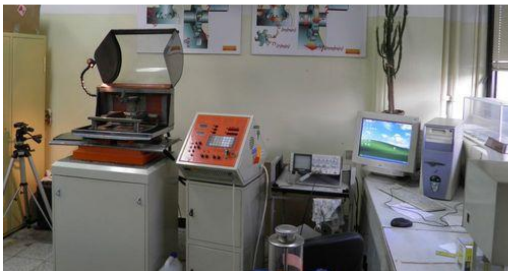
Rys. 1. Stanowisko badawcze na bazie elektroerozyjnej wycinarki drutowej BP - 95d, podłączonej do oscyloskopu typu KIKUSUI COR 5541U oraz komputera klasy PC
