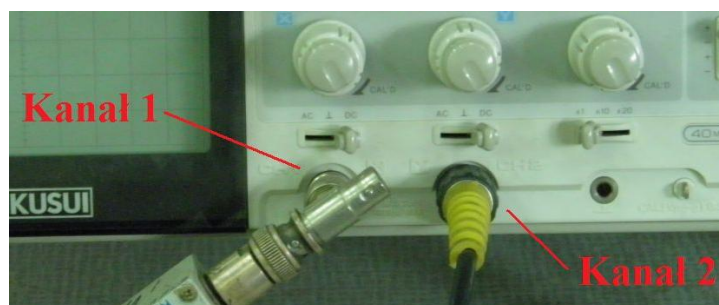
Rys. 2. Sposób przyłączenia przewodów sygnałowych do oscyloskopu cyfrowego Fig. 2. The method of the digital oscilloscope connection
