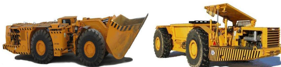
Rys. 4. Ładowarka i wóz odstawczy stosowane w oponowym transporcie cyklicznym w górnictwie rud miedzi (źródło: http://www.kghmzanam.pl/ )
