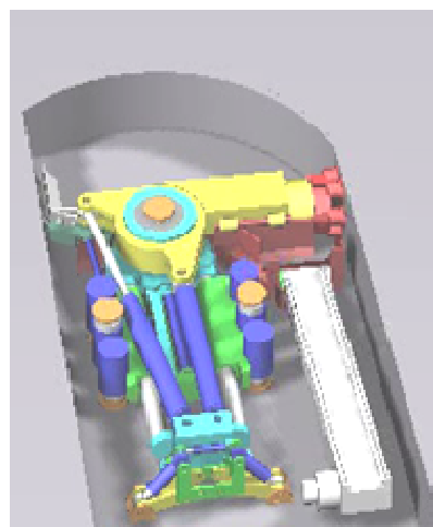
Rys. 7. Kształt zabierki wykonywanej kombajnem ARM-1100 (obrotową głowicą na wychylnym ramieniu) Fig. 7. Cutting shape made by roadheader ARM–1100 (cutting head on pivoting arm)
