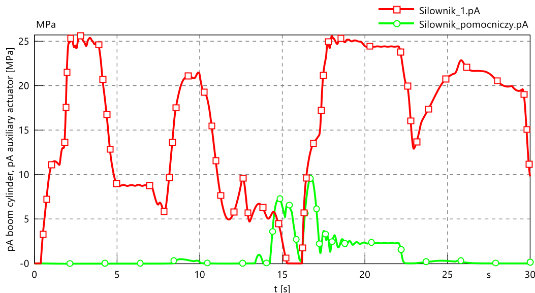
Rys. 4. Charakterystyki ciśnień siłownika wysięgnika i siłownika pomocniczego
