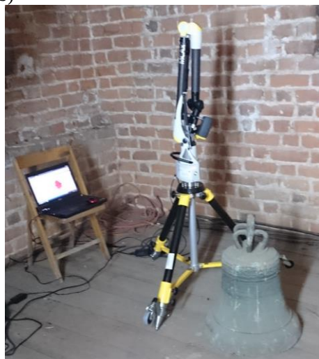
Rys. 8. Ramię pomiarowe MCAx20 użyte do digitalizacji dzwonów Fig. 8. Measuring arm MCAx20 used in digitization of bells
