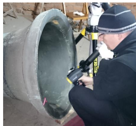
Rys. 8. Ramię pomiarowe MCAx20 użyte do digitalizacji dzwonów Fig. 8. Measuring arm MCAx20 used in digitization of bells
