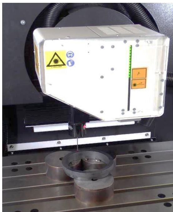
Rys. 1. Głowica laserowa typ LH3ax obrabiarki Fig. 1. The laser head type LH3ax of machine tool
