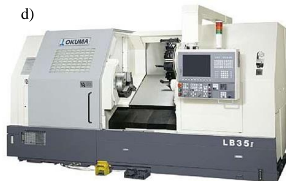
Rys. 18. Gniazdo elastyczne (a) zrobotyzowane (b), centrum obróbkowe 5-osiowe (c), centrum tokarsko-frezarskie Okuma (d)
