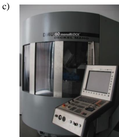
Rys. 18. Gniazdo elastyczne (a) zrobotyzowane (b), centrum obróbkowe 5-osiowe (c), centrum tokarsko-frezarskie Okuma (d)
