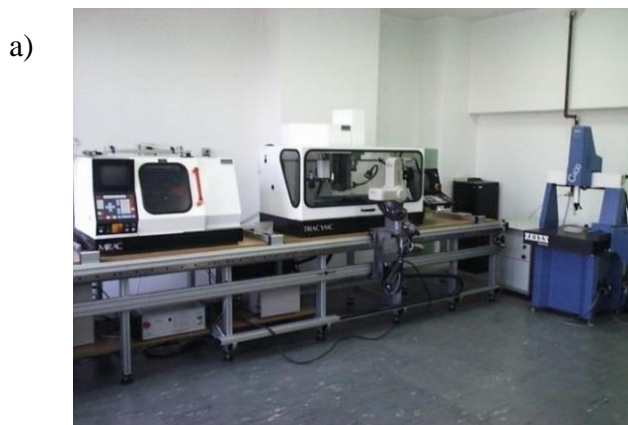
Rys. 17. Maszyna pomiarowa Accura firmy Zeiss (a) i ramię pomiarowe RA 7320 firmy Hexagon (b) Fig. 17. Accura coordinate measuring machine (a) and Hexagon measuring arm RA 7320 (b)
