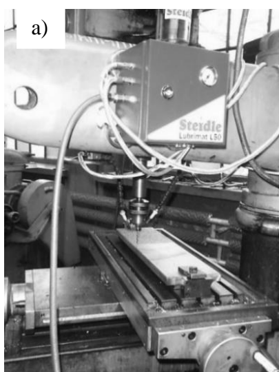
Rys. 22. Widok oryginalnego przyrządu do dozowania cieczy (a) i przykładowe wyniki badań eksperymentalnych (b) Fig. 22. View of original dosing device for liquid cooling (a) and example results of experimental research (b)
